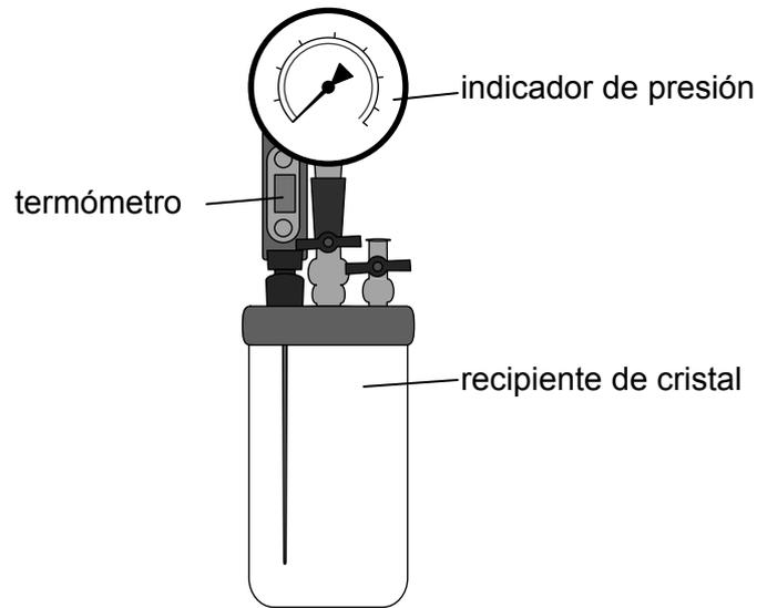
Se enfría el aparato en un congelador y se mete después en un baño de agua de modo que la temperatura del gas aumenta lentamente. Se registran la presión y temperatura del gas.
