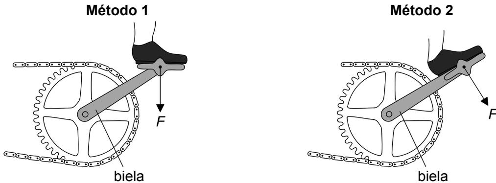
En el método 1, el pedal se mantiene siempre horizontal respecto al suelo. Un alumno afirma que el método 2 es mejor porque el pedal se mantiene siempre paralelo a la biela. Explique por qué el método 2 es más eficaz.
