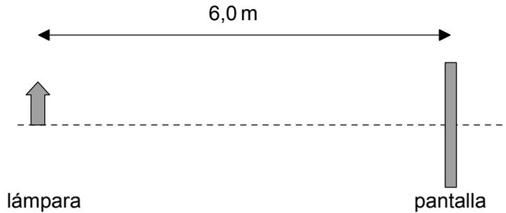
En un punto entre la lámpara y la pantalla se coloca una lente de modo que se produce una imagen real invertida sobre la pantalla. La imagen producida es 4,0 veces mayor que la lámpara.
